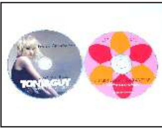
Offset (links) und Siebdruck (rechts). Fotorealistische Farbverläufe (Offset) vs. kräftige Farben (Siebdruck)
